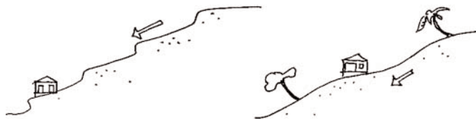
a) Pentes comportant des bourrelets ou des arbres inclinés, témoins d'un glissement récent
