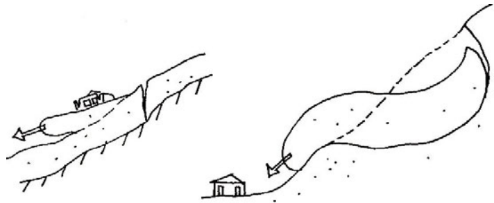
Fig. 23 - Glissement de terrain. Les constructions concernées sont emportées, qu'elles soient parasismiques ou non
